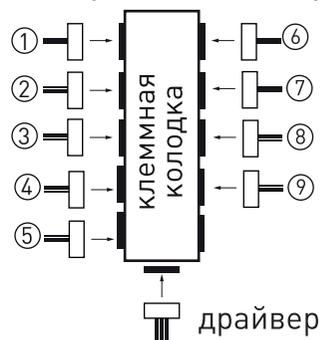
Клемма для коммутации проводов и драйвера
